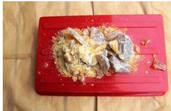
Abbildung 7: Kolophonium, ein natürlicher Bestandteil des Kiefer-/ Tannenbalsams, der auch bei der Destillation des Baumharzes anfällt
